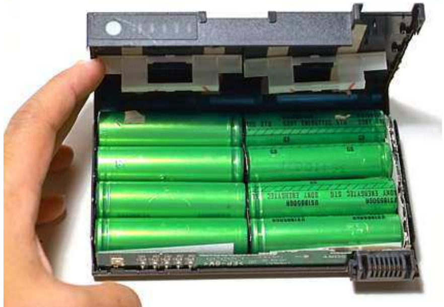
Cấu trúc bên trong pin Li-ion của hãng máy tính Dell
