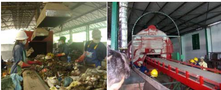
Phân loại rác thải và dây chuyền công nghệ xử lý rác thải đang vận hành tại Nhà máy xử lý rác Thủy Phương, Tp. Huế
