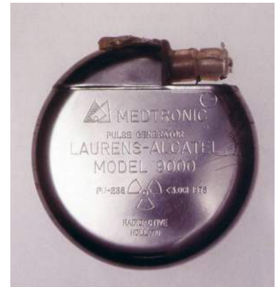
Sản phẩm máy tạo nhịp tim Medtronic sử dụng pin hạt nhân có thể sử dụng đến 35 năm kể từ ngày sản xuất.
