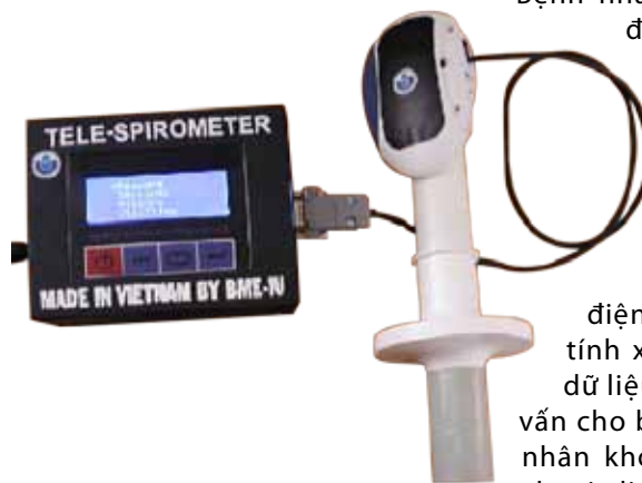
Máy hô hấp ký từ xa mẫu thiết kế tại Bộ môn Kỹ thuật Y sinh
