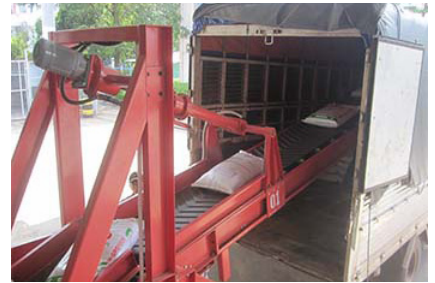
Hình ảnh ứng dụng của hệ thống băng tải chuyển hàng dạng bao lên xe tải.
