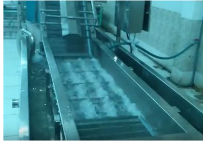
Máy rửa dùng cơ chế dòng chảy ngược.
