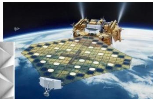
Kiểu gấp "Miura-ori" được ứng dụng để thiết kế tấm pin mặt trời năm 1995.
