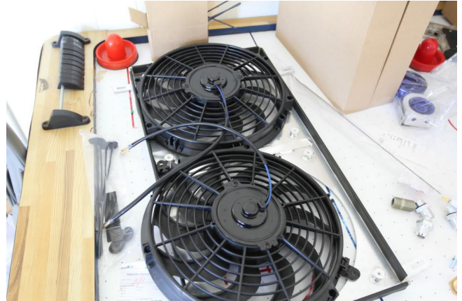
Dưới mặt bàn có quạt tạo nên “đệm không khí” để đĩa nhựa di chuyển nhanh hơn.
