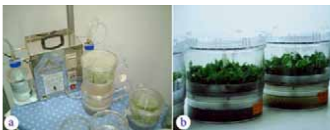
a: bình Plantima với hệ thống điều khiển chu kỳ ngập; b: cây sinh trưởng và phát triển trong hệ thống Plantima.
