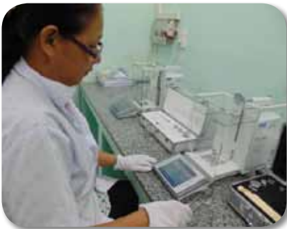
Cân hiệu chuẩn cho quả cân có yêu cầu rất cao về nhiệt độ cũng như thao tác của thí nghiệm viên. Ảnh: H.M.
