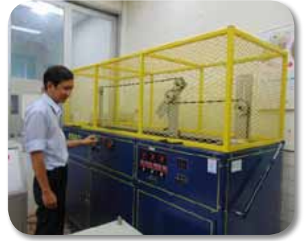
Vận hành thiết bị thử tính mềm dẻo của cáp với mỗi lần thử thiết bị sẽ kéo dài cáp đến trên 10.000 lần. Ảnh: H.M.
