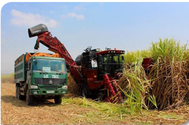
Thu hoạch mía bằng máy có thể đạt 800 tấn/ngày, tương đương 800 lao động. Nguồn: TTC
