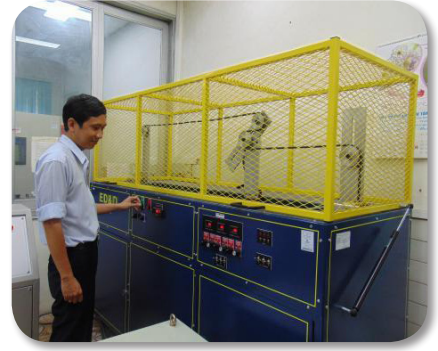
Vận hành thiết bị thử tính mềm dẻo của cáp với mỗi lần thử thiết bị sẽ kéo dài cấp đến trên 10.000 lần. Ảnh: H.M.
