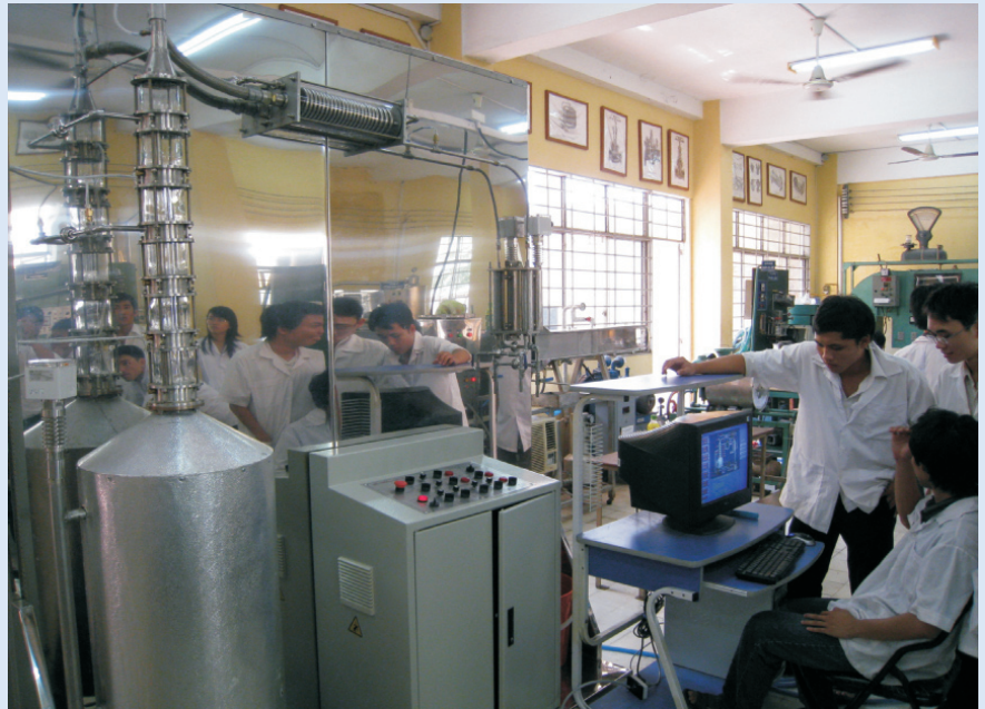
“Thiết bị hệ thống tự động hóa quá trình chưng cất” của TS. Lê Phan Hoàng Chiêu – Phó Giám đốc Trung tâm Neptech – được sử dụng trong công tác đào tạo tại các trường đại học, cao đẳng.
