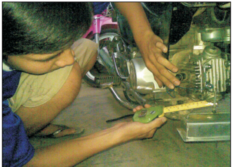
Sinh viên Ngô Phương Chấn lắp đặt thiết bị hút đinh vào trước lốc máy xe.
